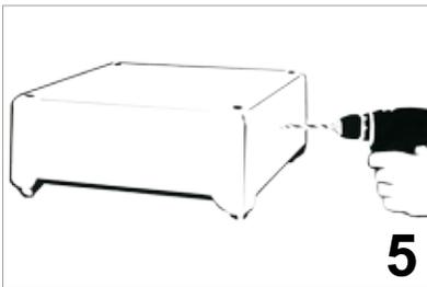
5. Loch bei vorgesehener Ausbruchstelle für Leerrohr bohren.
