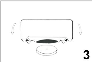
3. Zusammengesetzter Mauerkasten über Adapterrondelle stülpen.
