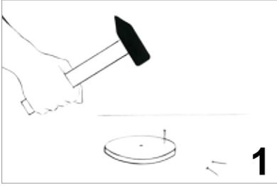
1. Adapterrondelle an der vorgesehenen Position des Lautsprechers mit 3 - 4 Nägel auf die Schalttafel nageln.
