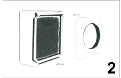
2. Adapter und Mauerkasten zusammensetzen.
