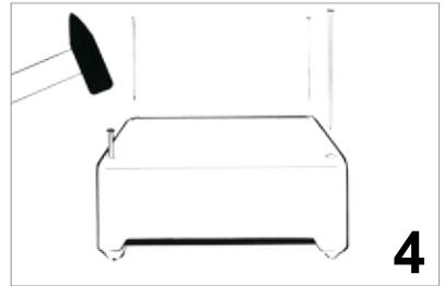
4. Mauerkasten mit den mitgelieferten **ALU-Nägeln** auf der Schalung befestigen.
