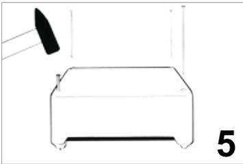
5. Mauerkasten mit den mitgelieferten **ALU-Nägeln** auf der Schalung befestigen.
