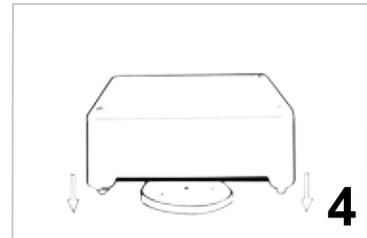
4. Zusammengesetzter Mauerkasten über Adapterrondelle stülpen.
