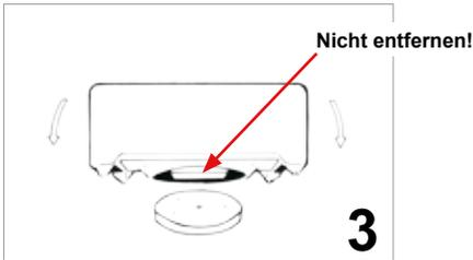
3. Stütze (weisser Styropor) bleibt bis nach dem Entschalen im Mauerkasten.
